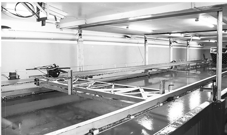
Экспериментальная установка — опытовый ледовый бассейн.
