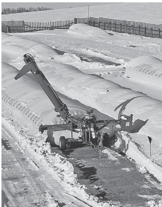
С современными технологиями и амбар не нужен, чтобы хранить зерно. Герметичные многослойные рукава лежат прямо на земле, и ни холода зерну не страшны, ни грызуны.
