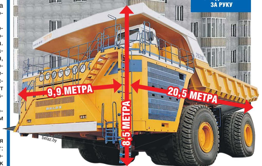
**ДИАМЕТР КАЖДОГО ИЗ ВОСЬМИ КОЛЕС - 4 МЕТРА, А ВЕС - БОЛЬШЕ 5 ТОНН**
