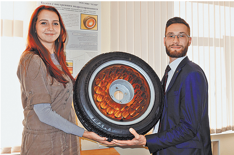
Инженер Анастасия Симакова и аспирант Степан Манфаровский демонстрируют изобретение — колесо с демпфирующей вставкой из полиуретана.
